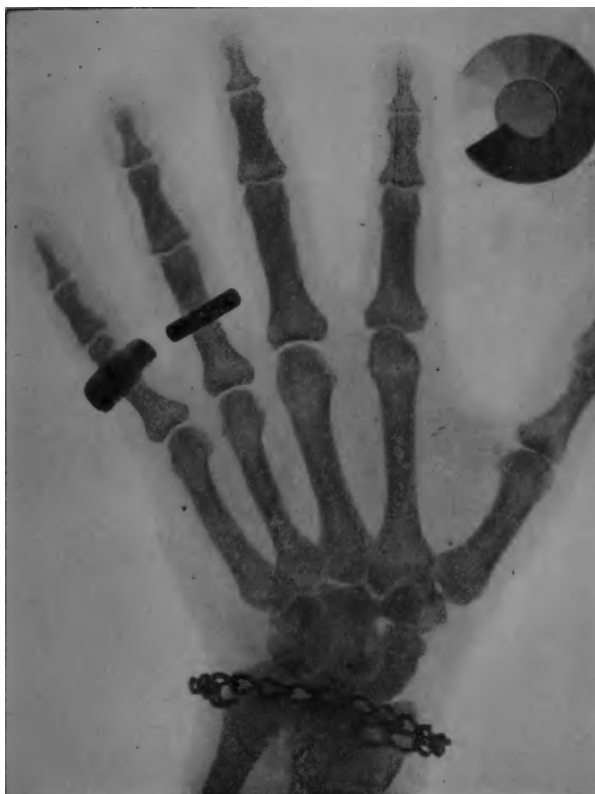
Planche II. — Radiographie d'une main (positif). A l'annulaire une bague d'or très opaque aux rayons X. Au petit doigt une bague d'aluminium bien moins opaque: l'ombre de l'os s'aperçoit au travers de cette bague. Au poignet un bracelet de fer avec une plaque d'aluminium mince, peu visible sur la radiographie en raison de sa transparence. Les os, bien moins opaques que les bagues, donnent cependant des ombres très nettes laissant voir des détails de structure. Le contour des chairs se voit faiblement. A côté de la main se trouve un radiochromomètre radiographié en même temps que celle-ci. Il indique une dureté de rayons de 6 e Benoist.
